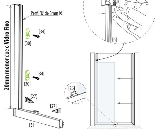
Corte o Perfil 'U' de 8mm [6] 20mm menor que o Vidro Fixo, parafuse [34] utilizando os protetores de parafusos [30] e vede. Encaixe o Vidro fixo no Perfil Guia [3] e ajuste o nível com a Cunha de Regulagem [27]. Coloque a Guia de Nylon [26] e trave o Vidro com o Perfil Camaleão [29].
