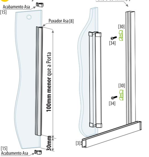
Corte o Puxador Asa [8] 100mm menor que a altura da porta e aplique o silicone. Cole o Puxador Asa [8] 30mm acima da borda inferior da porta. Encaixe os Acabamentos Asa [15]. **Atenção:** Puxador Asa [8] não pode atritar no Perfil Guia [3] e Perfil Trilho [1]. Ajuste a Porta com o Puxador no Perfil 'U' de 10mm [7], fixe-o [34] utilizando os protetores [30].
