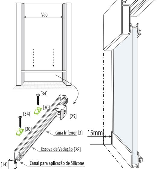
Confira as medidas dos vidros e do vão. Atenção ao nível e prumo. Corte o Perfil Guia [3] 3mm menor que o vão. Faça 2 furos com o Ø 4mm para fixar e 3 furos para escoamento da água. Coloque a Escova de Vedação [28], o Batente com Aba [25] e os Acabamentos da Guia [14]. Parafuse [34], utilizando os protetores [30].
