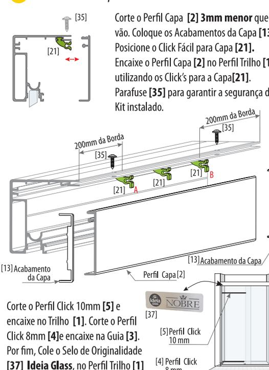
Corte o Perfil Capa [2] 3mm menor que o vão. Coloque os Acabamentos da Capa [13]. Posicione o Click Fácil para Capa [21]. Encaixe o Perfil Capa [2] no Perfil Trilho [1], utilizando os Click's para a Capa [21]. Parafuse [35] para garantir a segurança do Kit instalado.
