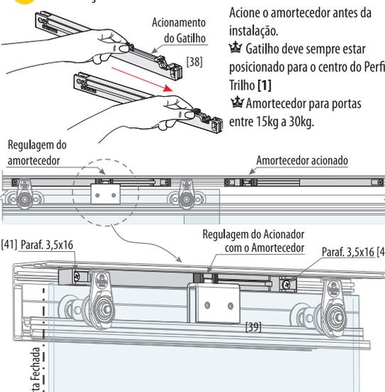
Posicione o Amortecedor [38] no Trilho [1], com o gatilho voltado para o centro do Perfil. Regule o Acionador [39] com o Amortecedor [38]. Engate a porta no gatilho do acionador e posicione a parada de fechamento. Fixo-o amortecedor. Em seguida repita o processo posicionando a parada de abertura.
