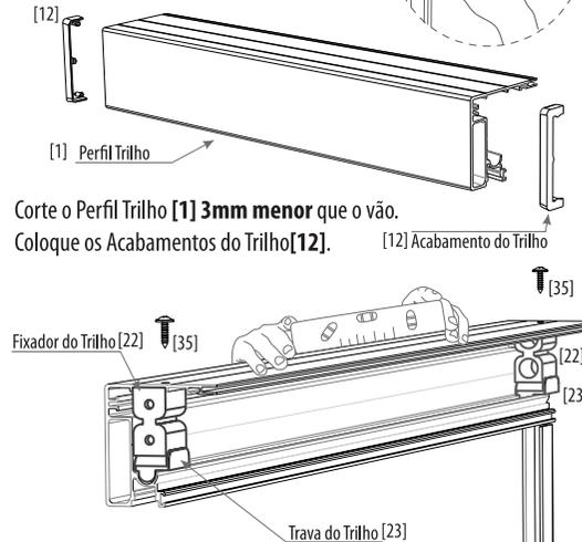
Corte o Perfil Trilho [1] 3mm menor que o vão. Coloque os Acabamentos do Trilho [12].
